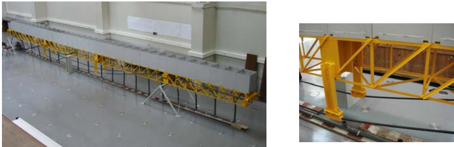
Figura 1: Modelo laboratorial com simulador de carga (“caixas” para enchimento com água)
